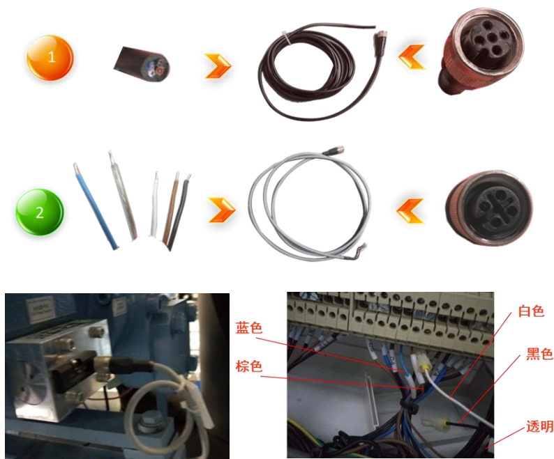
图 5-G(a) GHM 油流量开关电缆线及连接形式示意图
